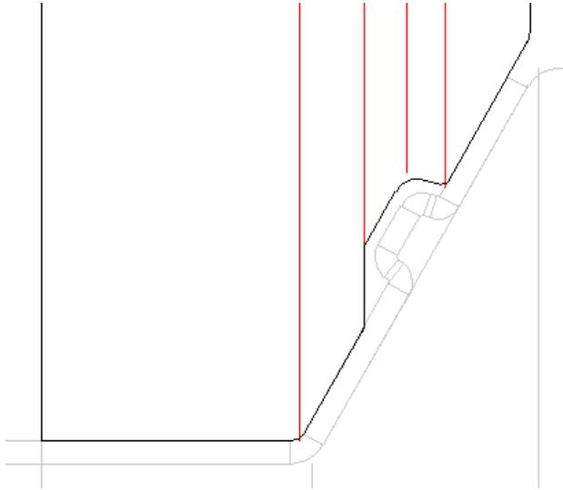
Mit der neuen Funktion **Parallelspalt** kann zwischen Rolle und Profil ein Spalt mit vorgegebener Spaltbreite erzeugt werden
