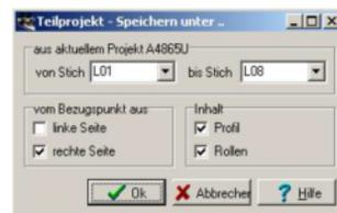
Mit der Funktion **Teilprojekt speichern unter..** lassen sich Teile eines Projekts, z.B. nur die linke oder rechte Seite, nur die Querschnitte der Profilblume ohne Rollen, oder nur ein Teil der Stiche, in eine Projektdatei abspeichern. Dies ist dann sinnvoll, wenn ein neues Projekt mit der Funktion **Teilprojekt hinzuladen** aus bereits vorhandenen Bausteinen zusammengestellt werden soll.
